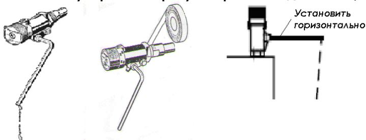
1 – сборка устройства; 2 – подмотка ленты фум; 3 – монтаж устройства.
