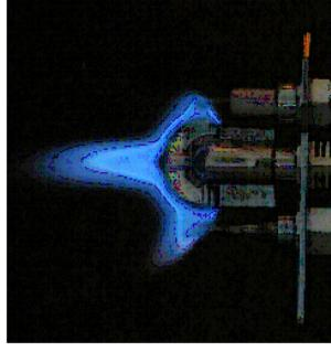
Отрегулировать пламя на пилотной горелке таким образом, чтобы слева от фитиля (пилотной) запальной горелки пламя было достаточным, чтобы прогреть терморпару (термопара наполнину должна охватываться пламенем).
